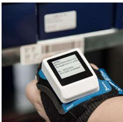
Das Display der SmartWatch. Die Workflows werden den Mitarbeitern Schritt für Schritt angezeigt.
