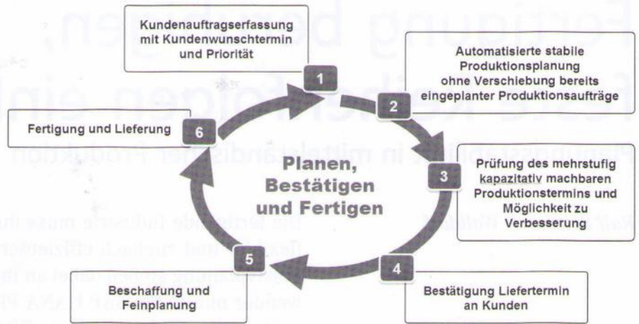
Bild 2. Ablauf des stabilen Produktionsplans (Quelle: CONSILIO IT-Solutions GmbH)
